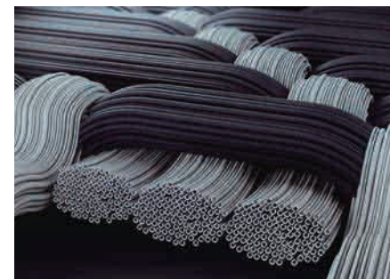
방적 단계에서 섬유의 안쪽을 공동으로 하여 기존 데님의 경량화를 실현시킨 특수 중공 섬유의 단면(확대 그림). 이 섬유의 발명으로 진을 경량화하는 것에 성공했다.
